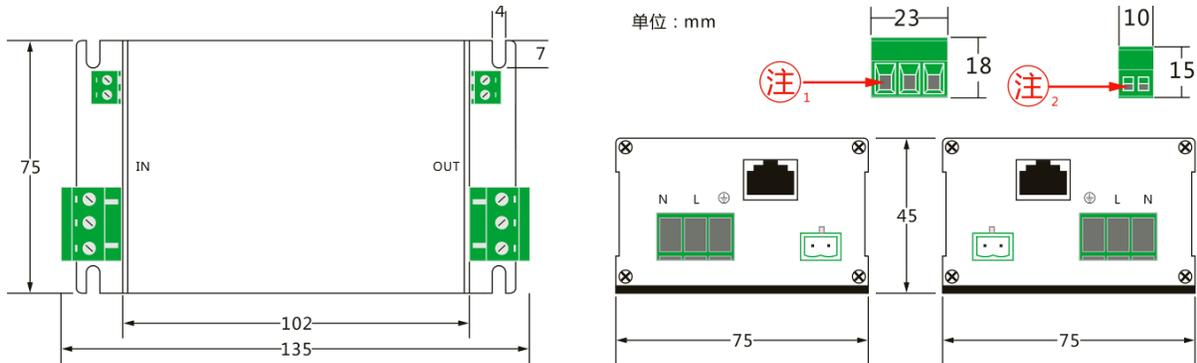
**注1**：此接线孔为螺丝拧接固定，建议容纳  $> 1\text{mm}^2 < 10\text{mm}^2$  的线缆。
